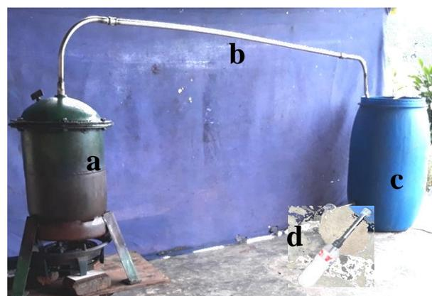
**Gambar 1.** Kontruksi alat pembuat asap cair a).Tabung Pirolisator b).pipa penyalur asap, c). Kondensor, d). Penampung asap cair.
